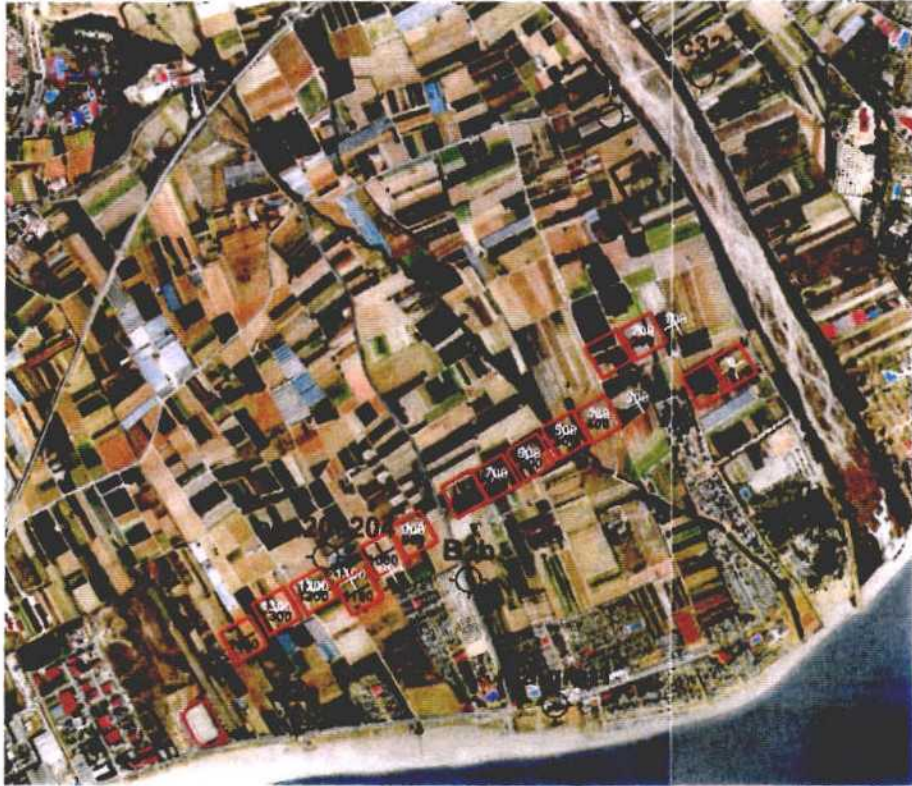
Figura 7.73 Posición de los sondeos mecánicos disponibles a lo largo del perfil PSI
